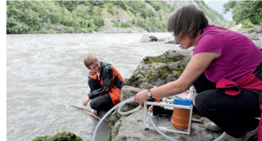
Entnahme und Analytik des Rheinwassers beim Projekt.
